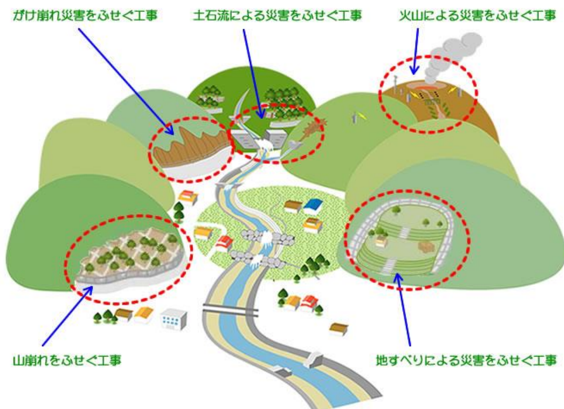
図6：土砂災害を防ぐための対策工事の例 出典：国土交通省北陸地方整備局
