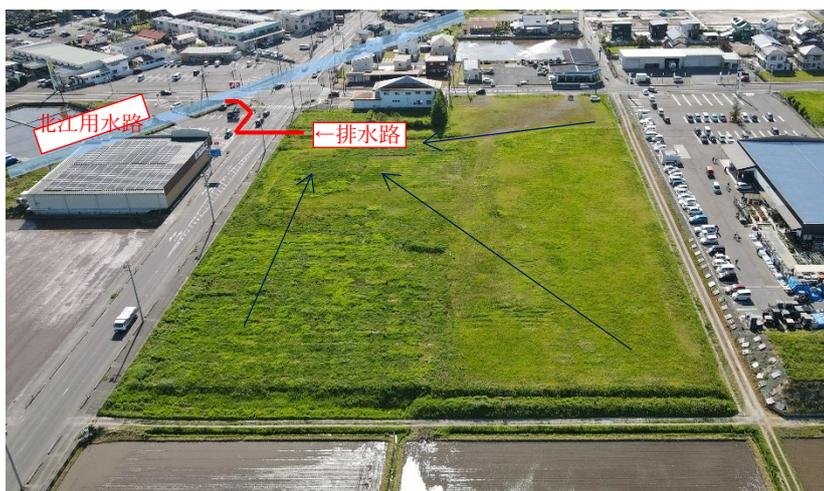
新庁舎の敷地には、雨水を一時的に貯めて、下流域の洪水被害の発生を防止・軽減するため、防災調整池を設ける必要があります。そこで、駐車場の一部を利用するなどの方法によって、敷地内に約 1 2 0 0 m<sup>3</sup> の貯水容量を確保する計画としております。
