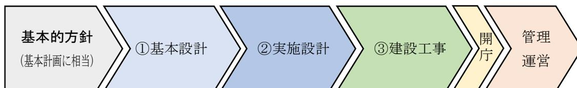
①基本設計…整備計画の諸条件や、各種の法令などの条件を前提として、施設の規模や構造、周辺整備に関する基本的な内容を、図面として分かりやすく示します。
